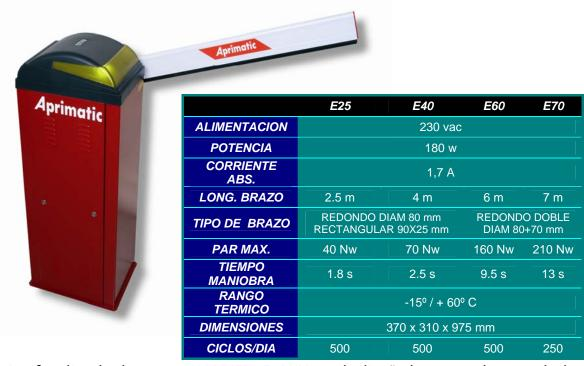
La familia de barreras HARRIER E LUX está diseñada para el control de vehículos con tráfico intensivo y elevada velocidad de maniobra requerida. Dispone de aceleración en la arrancada y deceleración en el final de recorrido lo que disminuye la carga en el reductor prolongando la vida del sistema.
