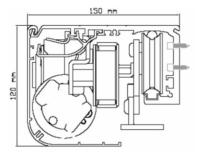
Automatismo para puertas correderas peatonales de una o dos hojas. Travesaño de medidas reducidas con guía de deslizamiento en nylon para disminuir el nivel de ruido y permitir la sustitución en caso de desgaste. Cobertor dotado de accesorios que permiten mantenerlo alzado durante las tareas de mantenimiento. Compatible con todas las perfilerías Aprimatic y la gran mayoría de perfiles comerciales.
