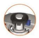
El encoder acoplado al árbol rápido dota al sistema de precisión total sobre la posición y velocidad de la puerta. Facilita por tanto arranques suaves, paradas con deceleración y, sobre todo, una sensible detección de obstáculos provocando la inversión del movimiento y grantizando la seguridad de los usuarios.
