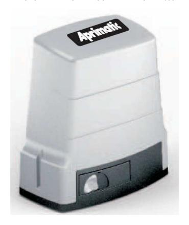
Operador de 230 Vac para puertas correderas hasta 600 Kg. Construido sobre un robusto monobloque de aluminio inyectado y lacado al horno con resina epoxi especial para exteriores. Dispone de un preciso encoder que facilita máximo control sobre la velocidad, fuerza y posición de la puerta. Incorpora cuadro de maniobras de fácil puesta en marcha con autoaprendimiento de los parámetros básicos de trabajo..
