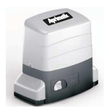
Operador de 230 Vac para puertas correderas hasta 800 Kg. Construido sobre un robusto monobloque de aluminio inyectado y lacado al horno con resina epoxi especial para exteriores. Dispone de un preciso encoder que facilita máximo control sobre la velocidad, fuerza y posición de la puerta. Incorpora cuadro de maniobras de fácil puesta en marcha con autoaprendimiento de los parámetros básicos de trabajo..
