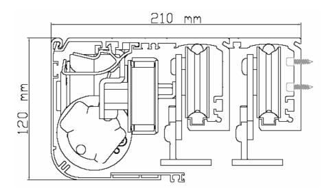
Automatismo para puertas correderas peatonales de dos o cuatro hojas. Travesaño de medidas reducidas con guía de deslizamiento en nylon para disminuir el nivel de ruido y permitir la sustitución en caso de desgaste. Cobertor dotado de accesorios que permiten mantenerlo alzado durante las tareas de mantenimiento. Compatible con todas las perfilerías Aprimatic y la gran mayoría de perfiles comerciales.
