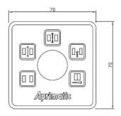
Selector de funciones con llave extraíble para evitar cambios de modo involuntarios. Permite seleccionar las funciones de Automático, apertura parcial, solo salida, abierto y cerrado.
