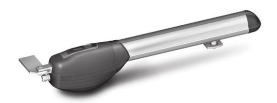
Operador electromecánico de 230 Vac para puertas batientes de hasta 3 mts. Construido sobre un robusto chasis de aluminio inyectado y lacado al horno con resina epoxi especial para exteriores.
