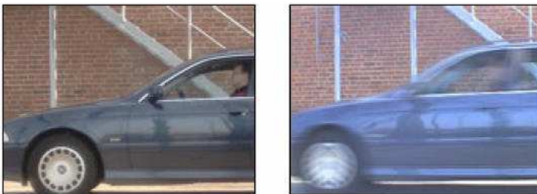
Fig. E.1. Comparativa para un vehículo en movimiento. Cámara con escaneo progresivo a la izquierda. Cámara PAL con escaneo entrelazado a la derecha.
