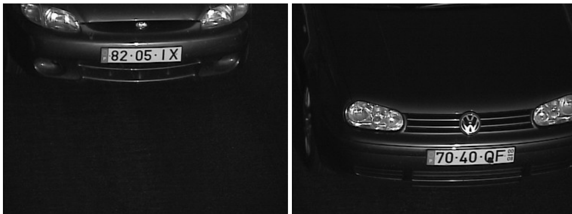
Fig. 5.3. Imágenes diurnas captadas por el sistema ParkingLPR en pleno día y a velocidades de paso superiores a los 150 km/h.
