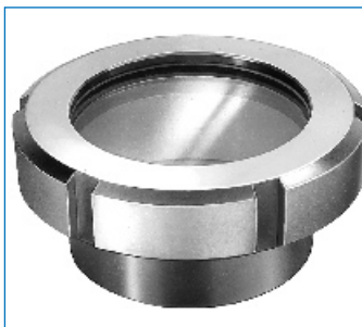
Mirillas roscadas similares a DIN 11851, PN 6, también con limpiacristales tipo W / WD
