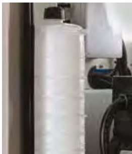
Depósito de agua destilada
