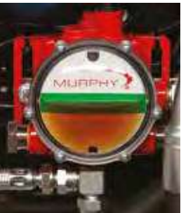
Sistema de mantenimiento de nivel de aceite
