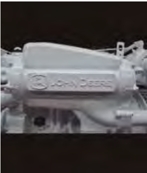
Múltiple de escape refrigerado por agua
