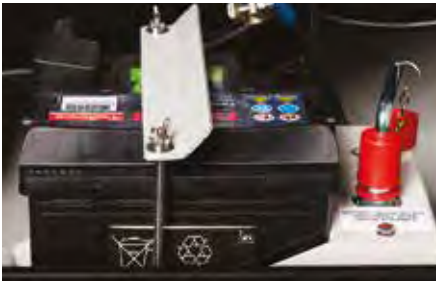
Batería con desconector
