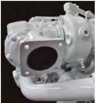
Turbo refrigerado por agua
