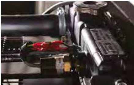
Sensor del nivel de refrigerante en radiador
