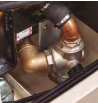
Válvula de selección para refrigeración por radiador/quilla
