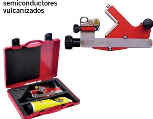
Adecuado para pelar la capa vulcanizada semiconductor de cables de polietileno reticulado, polietileno reticulado (XLPE) con diámetros de 10 a 52 mm.
