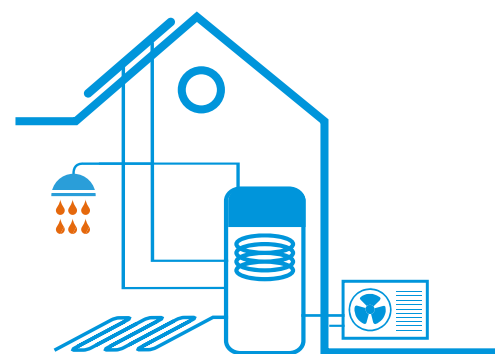
Daikin Altherma 3 R ECH 2 O (Compact con posibilidad de apoyo solar y/u otras fuentes de energía).
