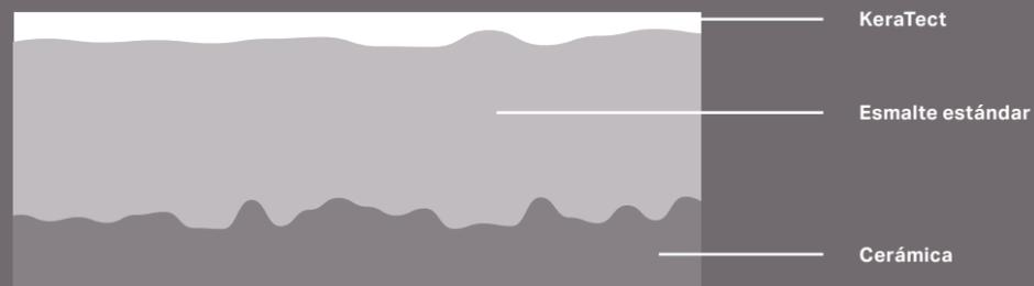
El acabado de Geberit KeraTect es muy resistente a agresiones externas, como las causadas por limpiadores abrasivos. Por eso Geberit garantiza la resistencia del esmalte y la suavidad de la superficie de la porcelana. Y ofrece tranquilidad, limpieza fácil y la higiene deseada.
