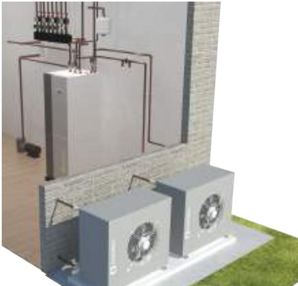
Esquema que proporciona una elevada captación para la combinación con los modelos ecoGEO 5-22, en situaciones en que las condiciones climáticas de diseño lo requiera. Consultar tarifa.
