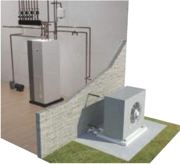
Esquema con bomba de calor con configuración aerotérmica, interesante para aquellos casos donde exista un clima benévolo, donde sea imposible perforar por razones de coste, tipología del terreno, por ser una zona protegida, etc.
