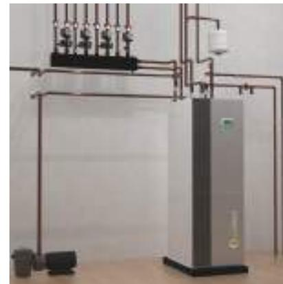
Esquema muy compacto que en pocos metros cuadrados de sala técnica engloba una instalación muy completa simplificando de tal manera que se evita la instalación de válvulas, acumuladores de inercia, etc. Con esta configuración se puede suministrar dependiendo del módulo, calefacción, frío pasivo, frío activo y agua caliente sanitaria. Serían necesarias las siguientes sondas: sonda exterior, sonda de ACS, señal activación de piscina y señal de activación de clima de cada una de las zonas.
