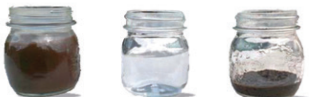
Agua de vegetación (izquierda) separada con BlueVap en agua limpia (centro) y concentrado (derecha)
