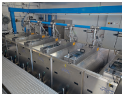
Calentadores Rápidos para extracción a baja temperatura (izquierda) y batidoras circulares con ahorro de energía Atmósfera (derecha)
