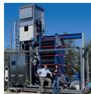
Decantador y batidoras circulares en COR (izquierda) y sistema de tratamiento de agua de vegetación BlueVap en Santa Tea (derecha)
