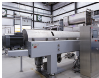
Decantador y batidoras circulares en COR (izquierda) y sistema de tratamiento de agua de vegetación BlueVap en Santa Tea (derecha)
