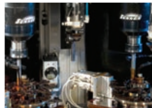
AL COMIENZO, EN EL MEDIO O FINAL DEL BRUÑIDO, LOS SISTEMAS SUNNEN INTEGRADOS DE MEDICIÓN NEUMÁTICA ASEGURAN EL TAMAÑO PRECISO DEL ORIFICIO Y RECTITUD, PIEZA TRAS PIEZA.
