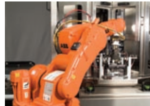
ROBOT SERVO MULTIEJES SE MUESTRA INTEGRADO EN SU SISTEMA DE BRUÑIDO MODULAR SUNNEN.
