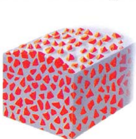
Figura 1: El recubrimiento de abrasivo consiste en varios estratos de grano utilizados uno después de otro
