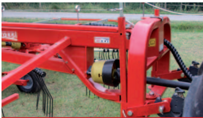
Attacco semiportato pivotante. / Semi-mounted pivoting hitch. / Enganche pivotante semi-suspendido. / Attelage semi-porté pivotant.
