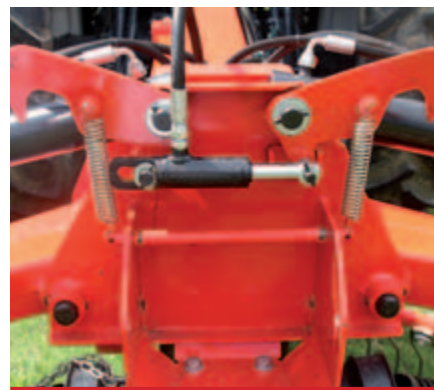
Blocco meccanico azionato automaticamente. / Automatic mechanical lock. / Bloqueo mecánico accionado automáticamente. / Système de verrouillage automatique.
