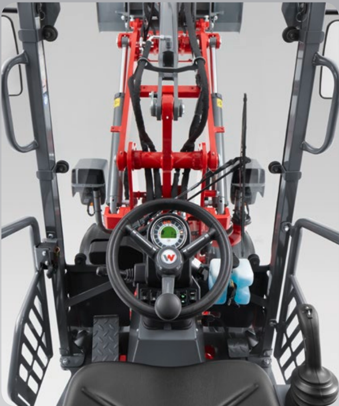
Buena visibilidad general. El techo de protección para el operador o la cabina garantizan una excelente visibilidad de los implementos, del área de trabajo y del entorno de la máquina.
