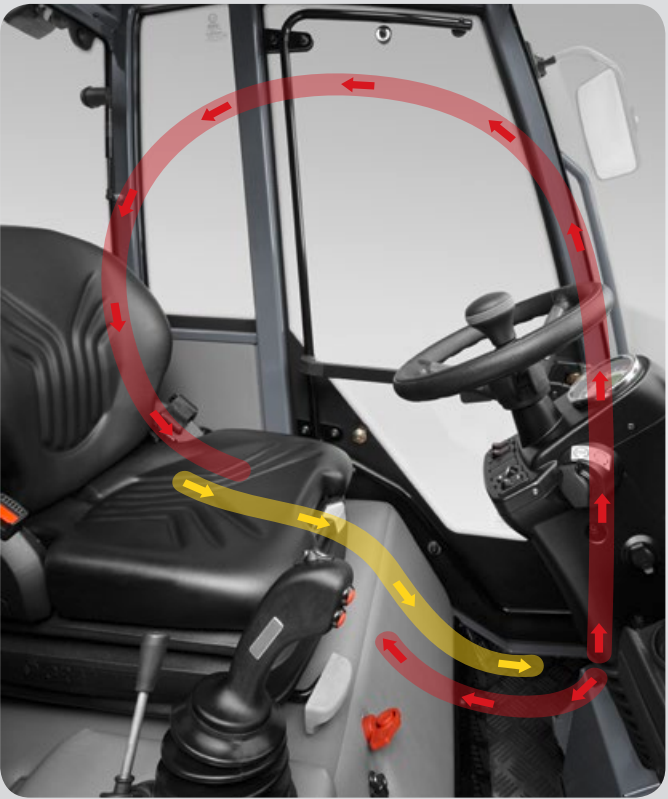
Temperatura de trabajo agradable. La climatización de trabajo es excelente gracias a la eficiencia de la calefacción y la ventilación con ventilador, filtro de aire fresco y toberas de ventilación bien distribuidas. En lugares con temperaturas exteriores especialmente altas, recomendamos el aire acondicionado (disponible para la 1880).
