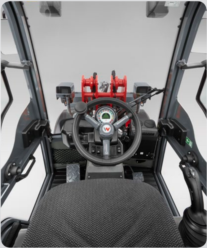
Ventilación cuando la necesita. La cabina dispone de grandes puertas a cada lado que pueden abrirse de par en par. El vidrio superior puede abatirse totalmente y fijarse según el modelo de cabina. También puede dejar una rendija abierta.
