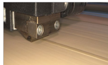
Aplicación de adhesivo uniforme y de precisión milimétrica
