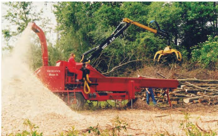
En 1992 Eschlböck lanzó al mercado la robusta astilladora de tambor Biber 7, con una boca de alimentación de 35 x 56 cm. Una astilladora con rotor abierto compuesto por discos con cuchillas separadas por parejas, que se convirtió en un ejemplo y referente en el mercado de las astilladoras.
