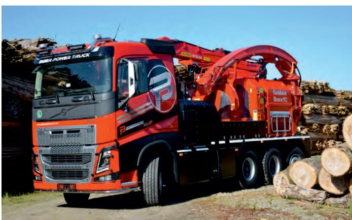
En el año 2015 se presenta la primera máquina de la línea Biber Powertruck. BPT es una línea perfecta de vehículos para el astillado. Con un chasis desarrollado especialmente por Eschlböck y transmisión a la astilladora, reúne el vehículo Biber Powertruck ambas características, una excelente movilidad sobre el terreno y una velocidad rápida capaz de alcanzar los 80 km/h.
