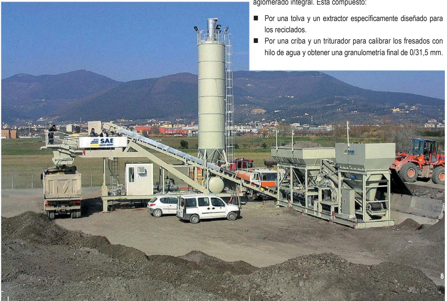
Criba y trituradora integrados en la central PACKLINER
