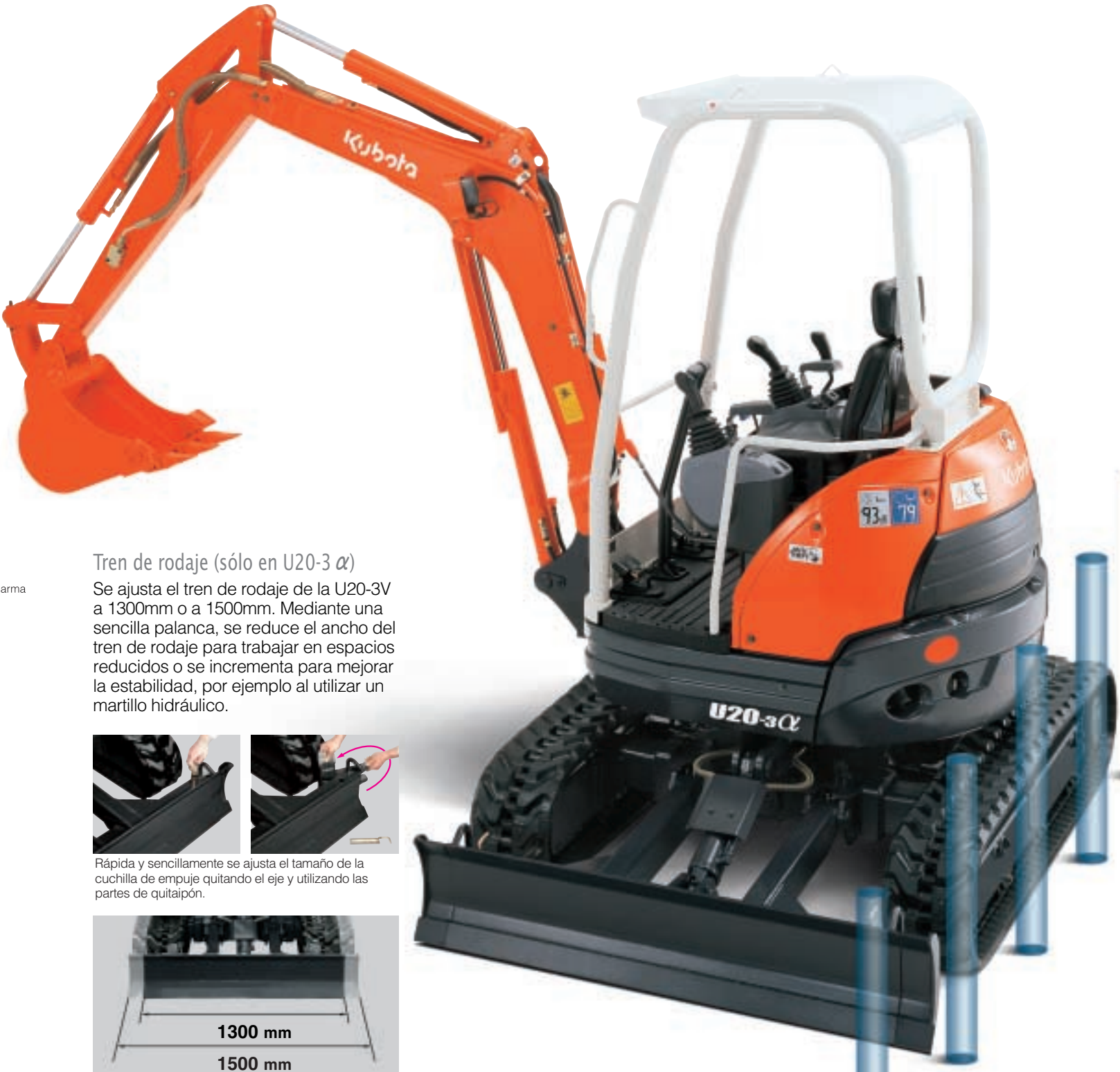
Incrementar el ancho del tren de rodaje para una mejor estabilidad o reducirlo para tener acceso a espacios estrechos.
