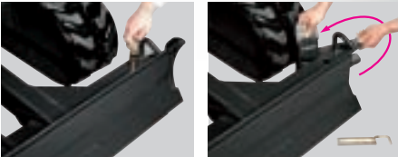
Rápida y sencillamente se ajusta el tamaño de la cuchilla de empuje quitando el eje y utilizando las partes de quitaipón.
