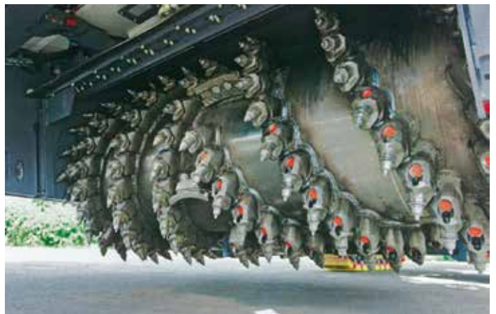
Picas de carburo, tungsteno y widia para trabajos en asfalto, hormigon y piedra. fabricadas en Alemania
