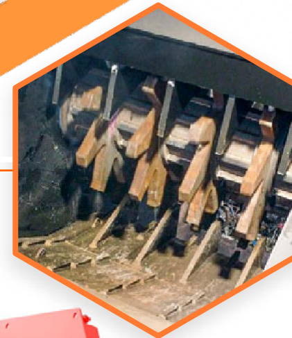
Rotores equipados con dientes de manganeso para garantizar un rendimiento elevado y continuo
