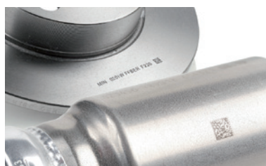
Ideal para marcage sobre metal – cambio de color; grabado, recocado
