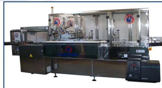
Máquina de funcionamiento continuo, para producciones de hasta **450/500 unidades por minuto**. Tanto para el estuchado de **conservas** como de productos **farmacéuticos** o **cosméticos**, entre otros. Fácilmente ajustable para una amplia gama de formatos. Cierre de solapas por encaste mecánico o por cola caliente.
