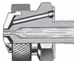
Combinación de aspersión por sifón de mezcla externa: Patrón de aspersión redondo
