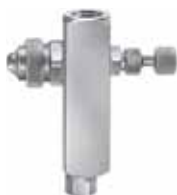
1/4JF y 1/4JFN conexión de entrada de aire 1/4" NPT o BSPT (H) conexión de entrada de líquido 1/8" NPT o BSPT (H)
