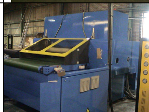
Vista trasera de la máquina, avance por sistema de rodillos neumáticos.
