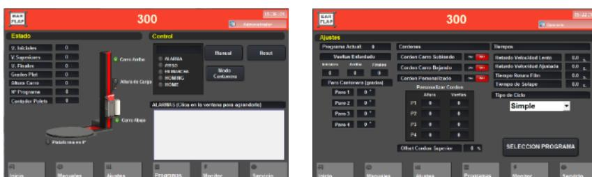
Fotos: Pantallas de configuración de ciclos de enfardado e información del estado de la máquina.
