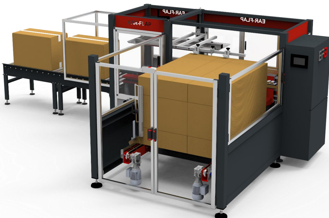
Foto: Formadora de cajas automática modelo BEM300 de salida izquierda con almacén de cajas horizontal motorizado + Transportadores de rodillos motorizados de salida
