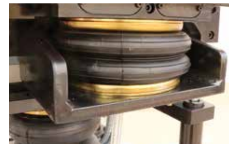
Sistema neumático para fijar el material. Pneumatic system to fix the plate.
