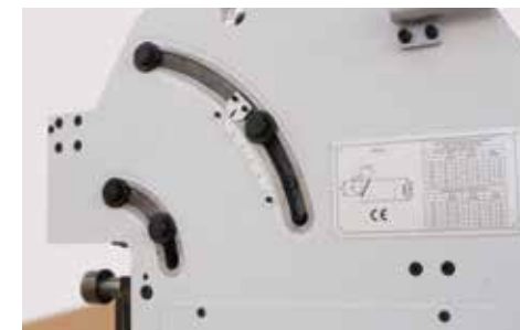
Ángulo de chaflanado preciso. Exact Bevel angle.
