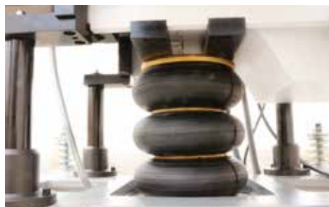
Sistema neumático para ajustar altura de trabajo. Pneumatic system to adjust working height.
