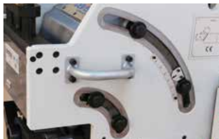
Ángulo chaflanado preciso. Exact Bevel angle.
