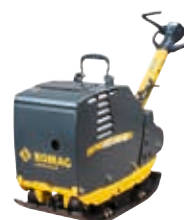
BPR 45/55 D Peso en funcionamiento: 395 kg Fuerza centrífuga: 45 kN Ancho de trabajo: 550 mm
