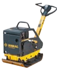
BPR 25/40 D Peso en funcionamiento: 150 kg Fuerza centrífuga: 25 kN Ancho de trabajo: 400 mm
