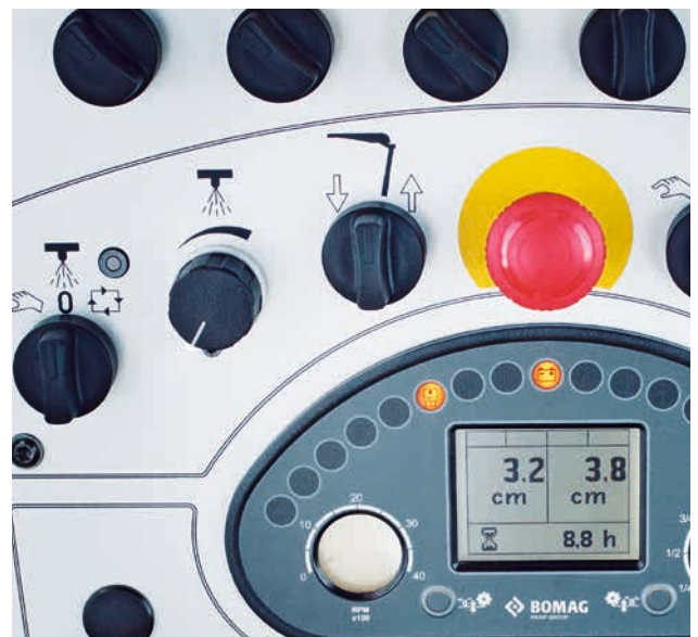
El riego de agua se regula con facilidad mediante dos interruptores de mando.
