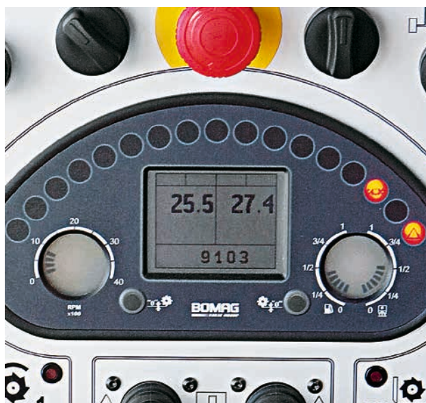
La indicación digital de la profundidad de fresado y el interruptor para la velocidad de avance se encuentran en el campo directo de visión del operario.
