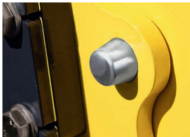
El perno de centrado protege la rosca de la puerta de la caja de fresado.
