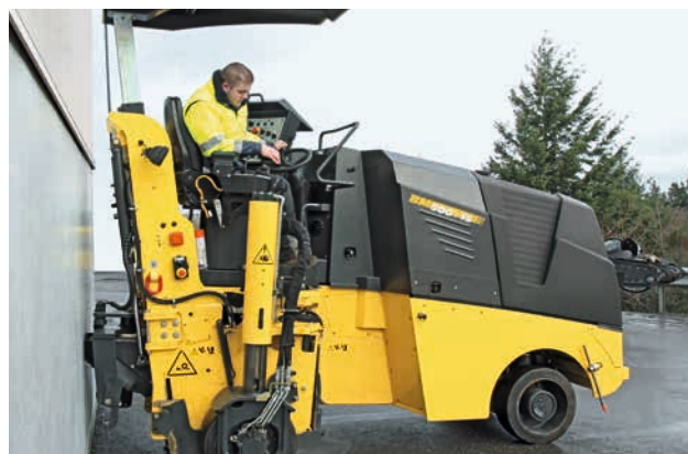
No hay ningún cilindro de ajuste estorbando en la parte trasera de la fresadora.
