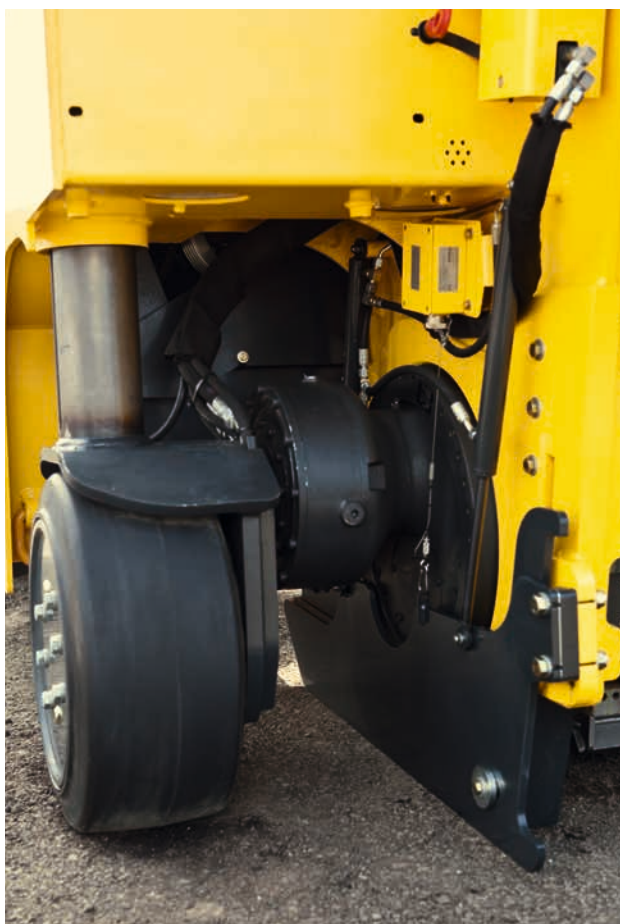
La placa lateral recta es especialmente robusta y duradera.
