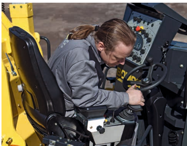
El asiento giratorio 45° grados proporciona una visibilidad inmejorable del camión de carga y del borde de fresado.
