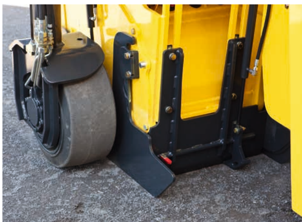
Patines deslizantes de metal duro, aguantan lo que haga falta.
