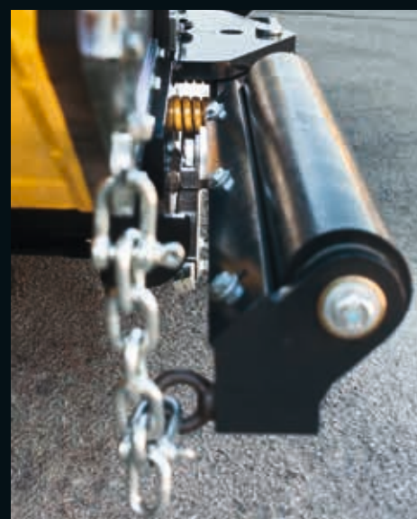
Montaje sin sacudidas gracias a los rodillos de empuje con amortiguación.
