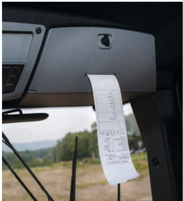
Impresora integrada: para documentar los valores de compactación.
