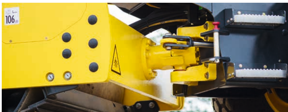
Una solución limpia: Ni la junta articulada requiere mantenimiento, ni la máquina engrase.
