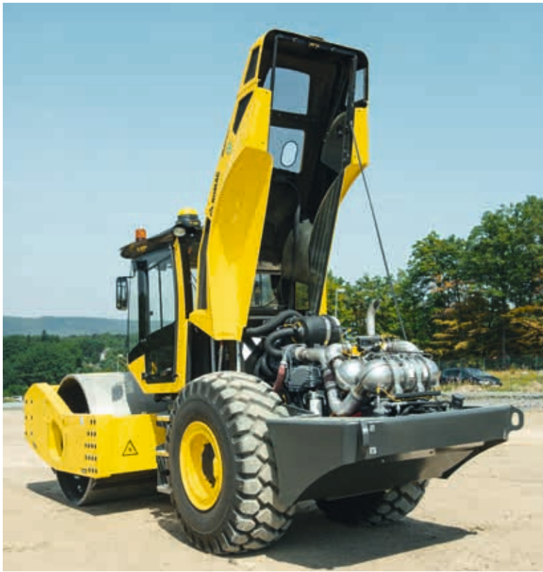
Una agradable apertura: sencillo acceso a todos los puntos de mantenimiento.
