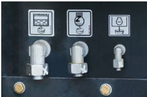
Inteligente: Los líquidos de funcionamiento pueden vaciarse desde el exterior.
