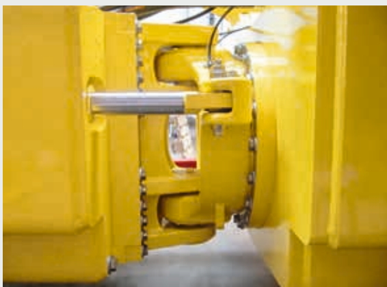
Una elevada tracción con la junta pivotante articulada (contacto permanente con el suelo).
