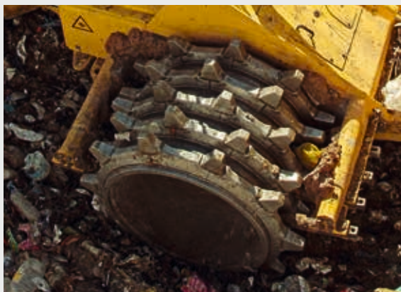
Ruedas limpias con rascadores efectivos (una compactación óptima).
