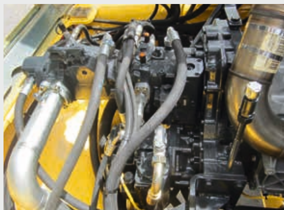
Tracción hidráulica de las ruedas con "control de límite de carga" (un control de velocidad en función de la carga) (BC 473).
