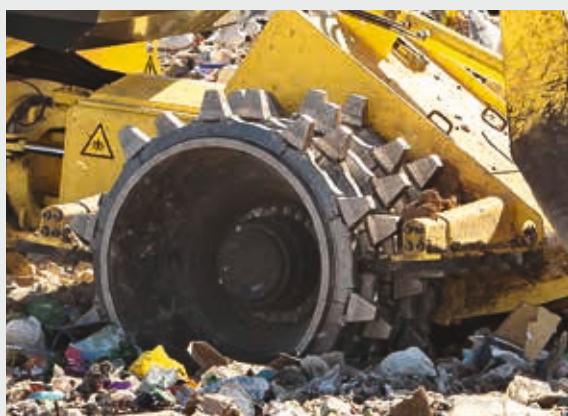
Los rascadores garantizan que las ruedas permanezcan limpias y una elevada compactación.
