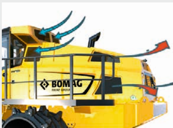
Aspiración de alto nivel para el aire de combustión y refrigeración con niveles mínimos de polvo.
