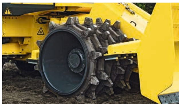
Los cuerpos soldados de las ruedas con conicidad interior por los dos lados maximizan la estabilidad (gama alta).
