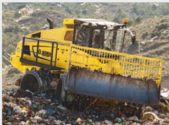
La compactación óptima con la junta pivotante obtiene una buena distribución de la carga hacia las ruedas de compactación.
