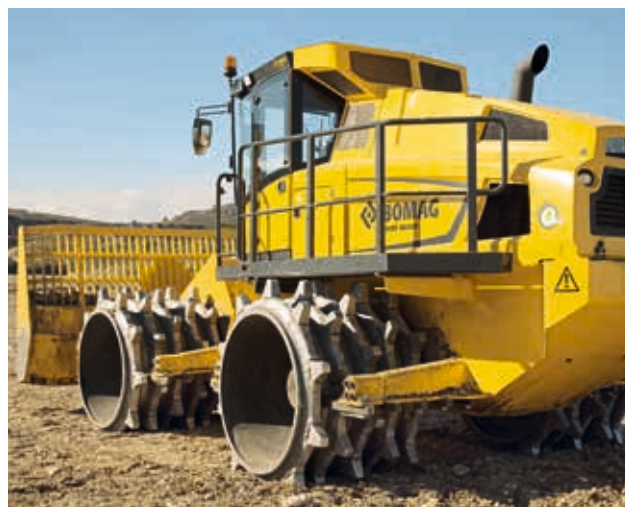
La plataforma de servicio permite acceder a la zona de mantenimiento.
