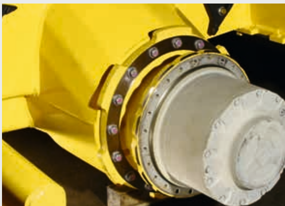
Dos sistemas independientes de frenos (hidrostático para el freno de servicio y multidisco para el freno de estacionamiento).
