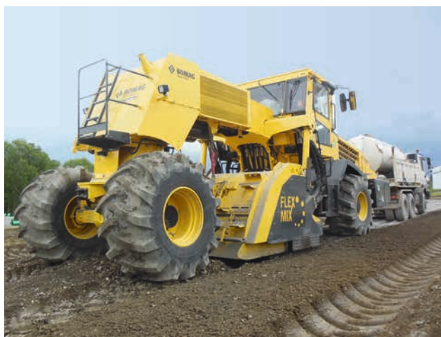
El MPH 600 se desenvuelve de maravilla en los terrenos más difíciles gracias a la dirección combinada articulada y de eje trasero.
