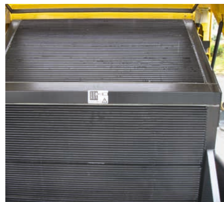
Radiadores de gran volumen con reservas suficientes.
