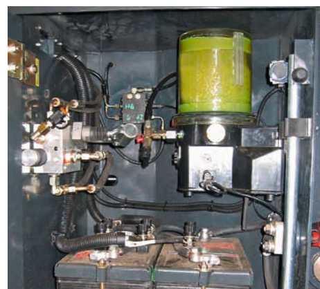
Equipo de engrase centralizado incluido de serie.
