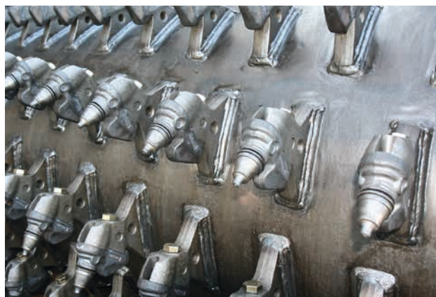
Sistema de portapicas reemplazable BRS 05 de BOMAG.
