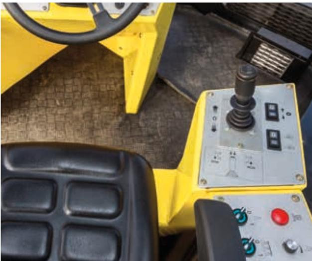
La palanca de marcha y el freno de rueda individual en el eje trasero aportan mayor precisión y capacidad de maniobra.
