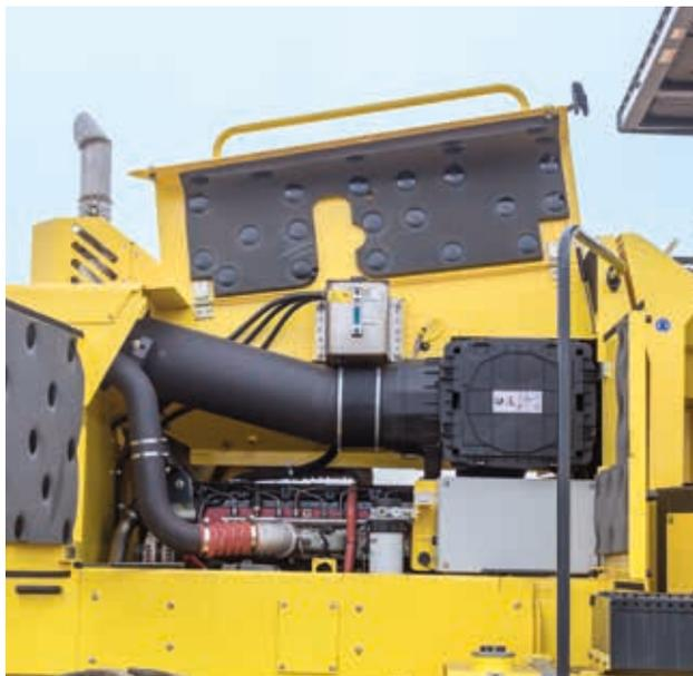
Capó del motor de amplia apertura.
