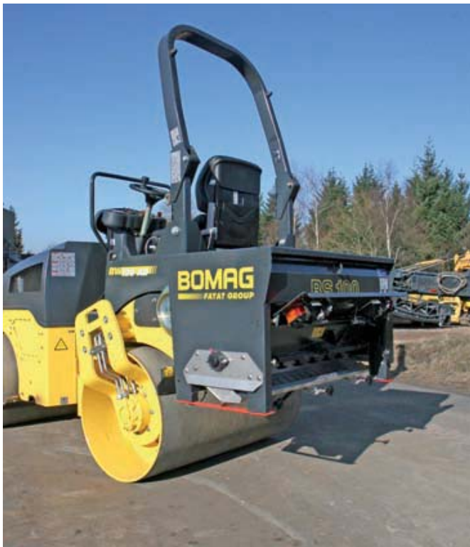
Fig. 41 BW 120 con esparcidor acoplado BS 100 y viga antivuelco plegable
