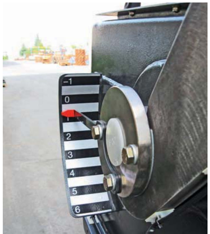
Fig. 74 Regulación de la cantidad esparcida
