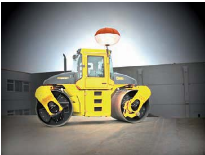
Fig. 43 rodillo tándem con conexión eléctrica de 230 V
