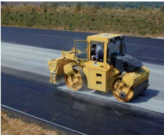
Fig. 72 El contenedor de material esparcido se puede desplazar lateralmente
