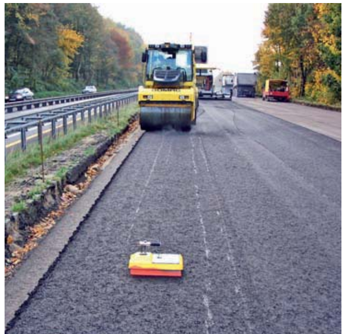
Fig. 83 Medición de densidad con sonda nuclear para compararla con el E_{VIB}
