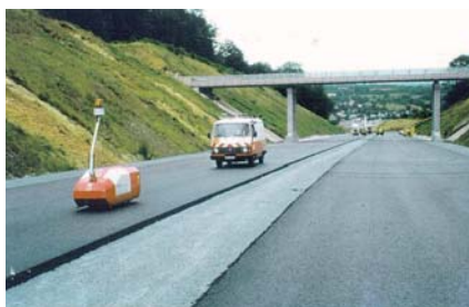
Medición continua de la compactación con sonda isotópica móvil [1 medición / 10 m]
