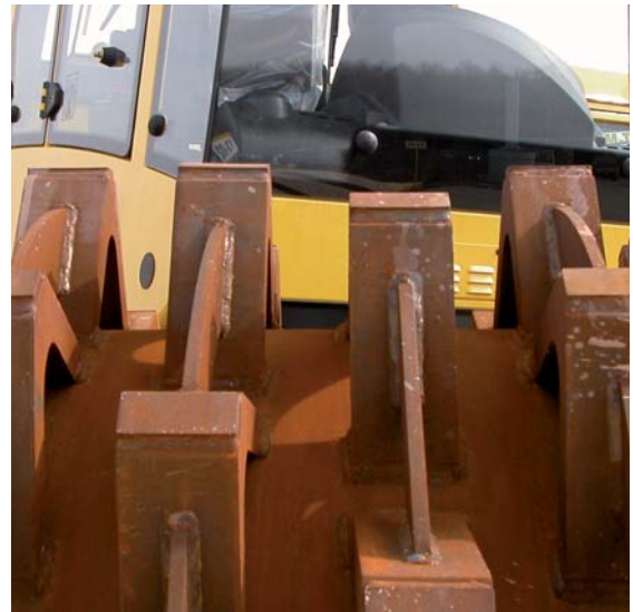
Figura 2: Herramientas trituradoras del rodillo RC
