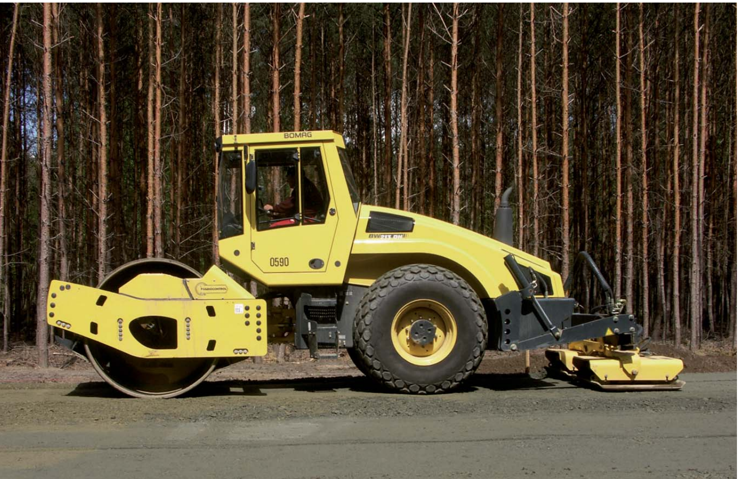
Figura 1: Rodillo autopulsado BOMAG BW 213 DH-4 BVC con bandejas vibrantes
