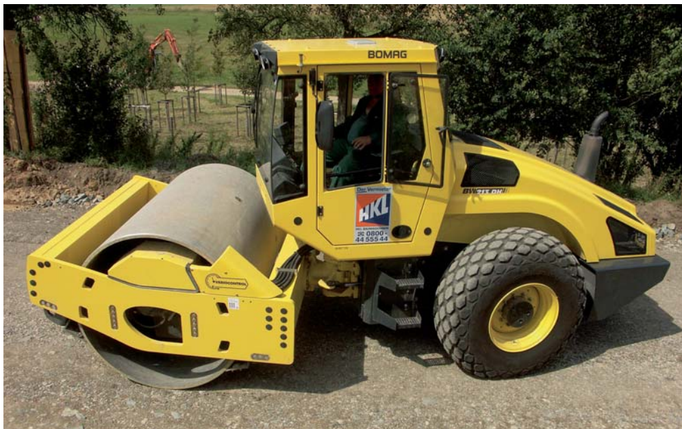
Fig. 1: Rodillo autopropulsado de 13 t con BVC en servicio
