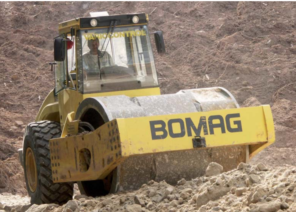
Figura 7: Justo en su sitio - el BW 226 DI-4 BVC durante el duro servicio en el movimiento de tierras.
