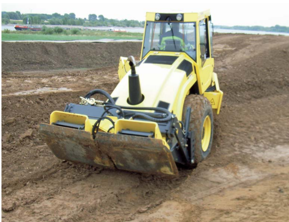
Figura 3: Rodillo autopropulsado con bandejas vibrantes en posición de transporte
