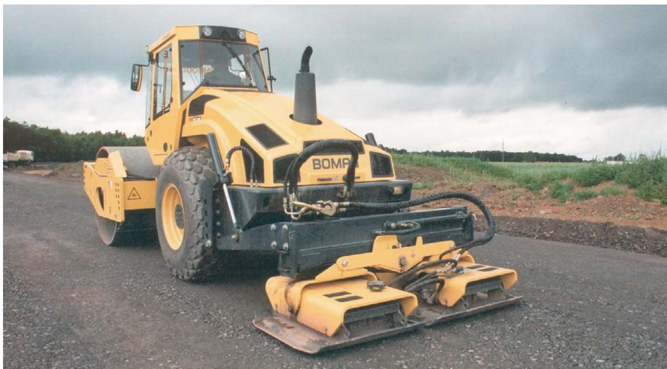
Figura 4: BW 213 DH-4 BVC con bandejas vibrantes en la autovía BAB A9
