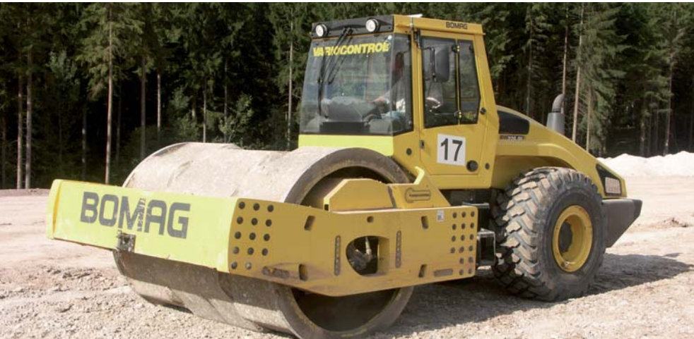
Figura 1: Rodillo autopropulsado BW 213 DI-4 BVC con rodillo poligonal
