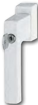
Manilla TOULON con función Secustik®, de aluminio, para ventanas oscilobatientes, con cuadradillo retráctil de 7x32-42 y tornillos M5x50 incluidos. Verificado según RAL-RG 607/9, RAL 100 cumple los requerimientos según DIN EN 1627-1630 RC1-6.
