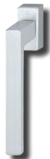
Manilla Grande HOPPE con función Secustik®, de aluminio, para puertas/ventanas correderas-paralelas-abatibles, correderas-paralelas y correderas simples 90°, línea TOULON: verificado según RAL-GZ 607/9. Con cuadradillo retráctil de 7x32-42 y tornillos M5x50 y M5x55 incluidos
