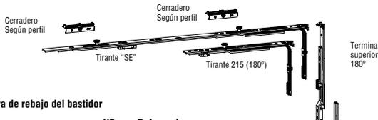
Herrajes necesarios según altura de rebajo del bastidor
