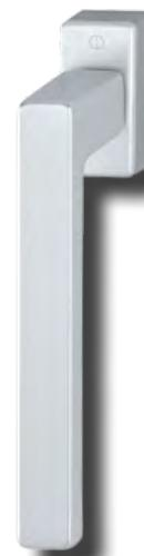
Manilla Grande HOPPE con función Secustik®, de aluminio, para puertas/ventanas correderas-paralelas-abatibles, correderas-paralelas y correderas simples 90°, línea TOULON: verificado según RAL-GZ 607/9. Con cuadradillo retractil de 7x32-42 y tornillos M5x50 y M5x55 incluidos
