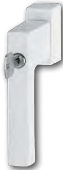
Manilla TOULON con función Secustik®, de aluminio, para ventanas oscilobatientes, con cuadradillo retractil de 7x32-42 y tornillos M5x50 incluidos. Verificado según RAL-RG 607/9, RAL 100 cumple los requerimientos según DIN EN 1627-1630 RC1-6.
