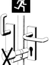
En cerradura anti-pánico nunca se deben de montar cilindros con pomo.
