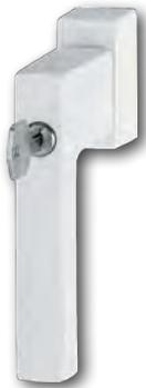
Manilla TOULON con función Secustik®, de aluminio, para ventanas oscilobatientes, con cuadradillo retractil de 7x32-42 y tornillos M5x50 incluidos. Verificado según RAL-RG 607/9, RAL 100 cumple los requerimientos según DIN EN 1627-1630 RC1-6.
