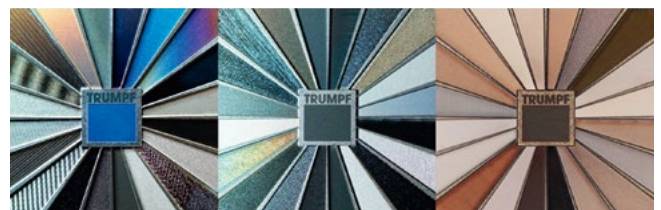
Marcados de alta calidad en el sector de la relojería: titanio (izquierda), 316L (centro), cobre (derecha).
