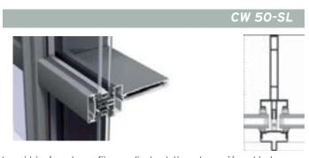
Los vidrios/paneles se fijan mediante pletinas de presión cubiertas por tapetas en forma de T de 8 mm de ancho. Puede incorporar todo tipo de ventanas. Montantes y travesaños de solo 15mm de espesor en cara interior.
