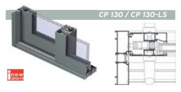
Correderas y correderas-elevables con rotura de puente térmico. Anchura marco correderas 130 mm (monorraíl y 2 guías) y 181 mm (3 guías), correderas-elevables 139 mm (2 guías) y 210 mm (3 guías). Peso máximo por hoja 300 kg . Acristalado hasta 42 mm.
