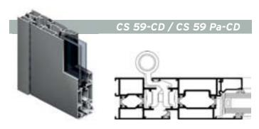
Sistema para puertas de 1 y 2 hojas, apertura interior o exterior con o sin rotura térmica. Anchura marco y hoja 50mm: aspecto enrasado. Altura galce 25mm. Junquillos con pósibilidad antirrobo. Doble junta perimetral. Utiliza bisagras enguiadas con eje desplazado. Acristalado hasta 35 mm.
