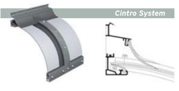
Sistema de perfilería apto para curvar. Permite techos ligeros con una anchura visible del perfil de 60 mm. Radio mínimo de curvado de 400 mm. Estanqueidad con juntas de EPDM. Acristalado hasta 32 mm.
