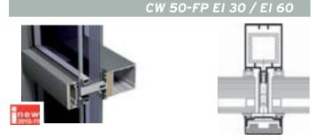
EI CW 50-FP EI 30 ofrece un periodo de resistencia al fuego de 30 minutos mediante la colocación de tubos de acero en los montantes y juntas especiales. EI CW 50-FP EI60 ofrece un factor de 60 minutos utilizando un material refrigerante. Acristalado hasta 33 mm.
