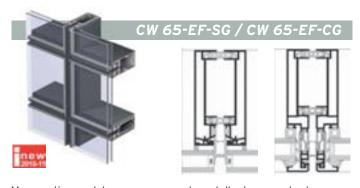
Muro cortina modular que se premonta en taller lo que se traduce en alta velocidad de colocación en obra. Permite muros cortina de tipo estructural o apanelado.
