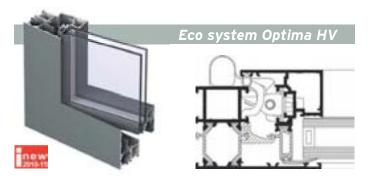
Sistema para ventanas de hoja oculta batientes, abatibles, y oscilobatientes. Anchura marco 50 mm y hoja de 60 mm. Rotura de puente térmico mediante pletinas de poliamida de 26 mm. Doble junta perimetral. Sistema únicamente válido para proyectos. Acristalado hasta 26 mm.
