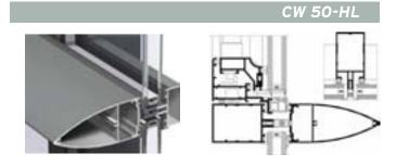
Los vidrios/paneles se fijan a la estructura de soporte mediante pletinas de presión horizontales que se cubren con tapetas ofreciendo un marcado tramado horizontal. Acristalado hasta 48 mm.
