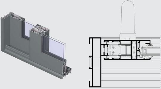
La serie AV-100 es un sistema de corredera sin rotura de puente térmico de grandes dimensiones y altas prestaciones destinada al cerramiento de amplios espacios, y que destaca por su aspecto robusto y agradable.
