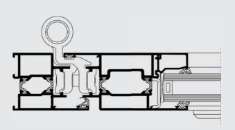
El CS59-CD es un sistema de tres cámaras con rotura de puente térmico exclusivamente para la realización de puertas, utilizando bisagras guiadas. Su extensa gama de perfiles permite fabricación de cerramientos atractivos y económicos.
