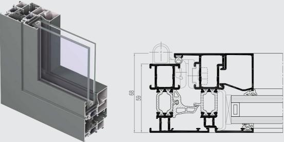
El CS 68 es un sistema de tres cámaras con rotura de puente térmico para puertas y ventanas, y constituye la combinación perfecta entre un valor de aislamiento alto y una seguridad óptima. Gracias a los junquillos tubulares el vidrio no puede extraerse desde el exterior.
