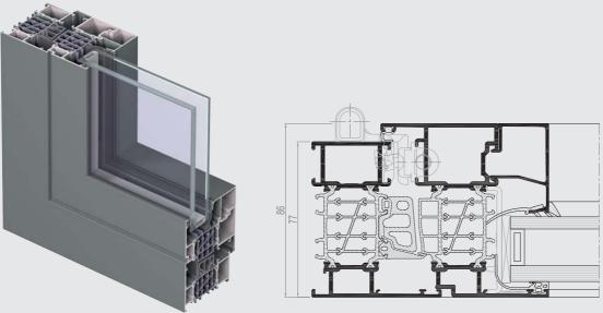
El CS 86-Hl es un sistema de tres cámaras con rotura de puente térmico para puertas y ventanas, que combina un diseño atractivo, una estabilidad óptima y un alto aislamiento térmico. Las pletinas de aislamiento esqueléticas internas dotan al sistema de un valor Uf de hasta 1.47 W/m²K, lo que lo convierte en el sistema que mejor eficiencia energética presenta de su gama.
